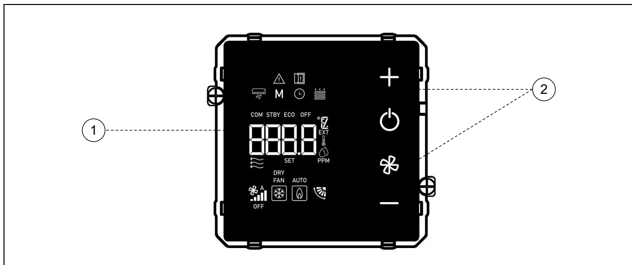
Figura 4 - Interfaccia utente: display (1) e LED touch retroilluminati (2)
