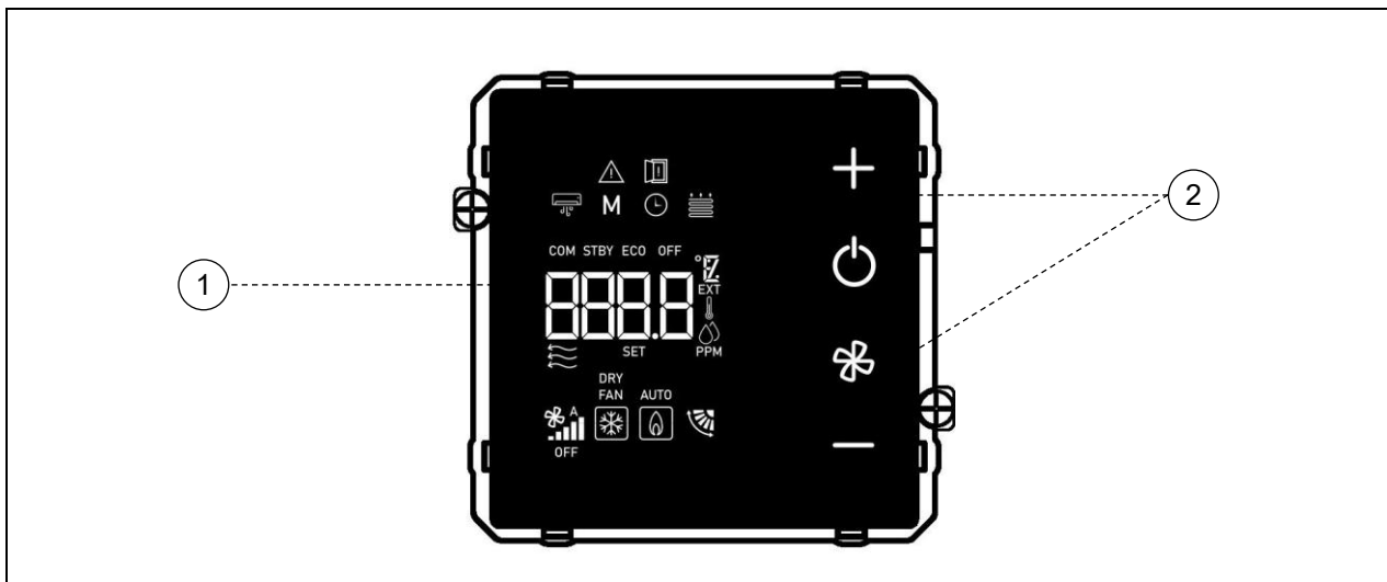
Figura 4a - Interfaccia utente versione Easy: display (1) e LED touch retroilluminati (2)
