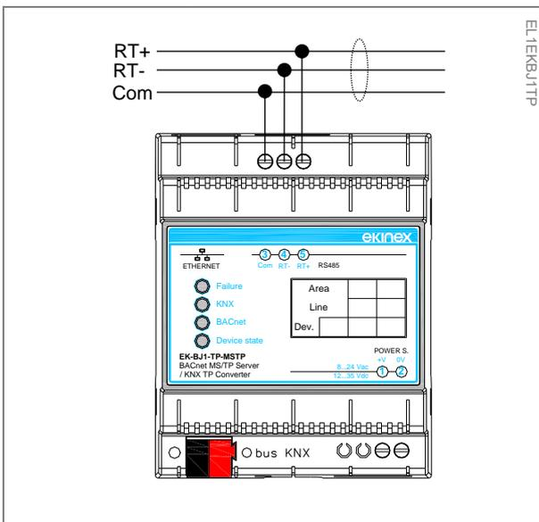
Per terminare la rete RS485 e bilanciare l'impedenza di linea, occorre inserire la resistenza terminatrice (120 Ω) portando il microinterruttore ad 1 via B in posizione ON.
