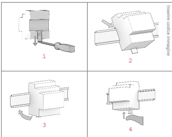
Per lo smontaggio dell'apparecchio, assicurarsi di avere scollegato le connessioni di rete e di avere disinserito il morsetto bus dal suo alloggiamento. Mediante un cacciavite far scorrere verso il basso il dispositivo di blocco e rimuovere l'apparecchio dalla guida profilata.
